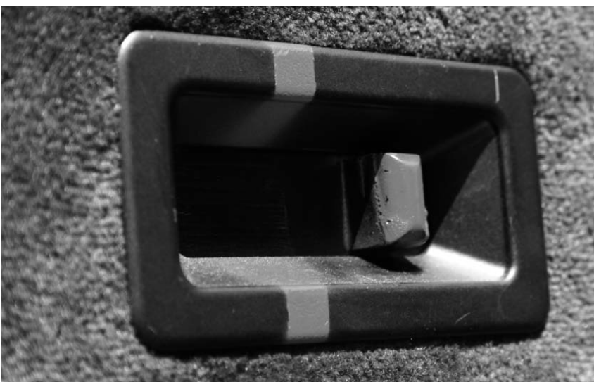
Tür auf – die geschlossene Stellung wurde mit einem roten Strich markiert Foto: Dave Richards
