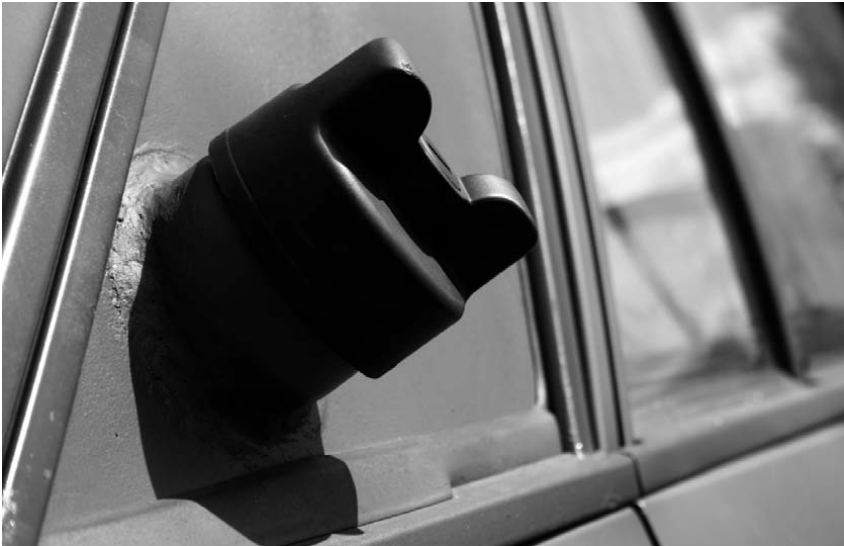
Außen liegender Tankstutzen
