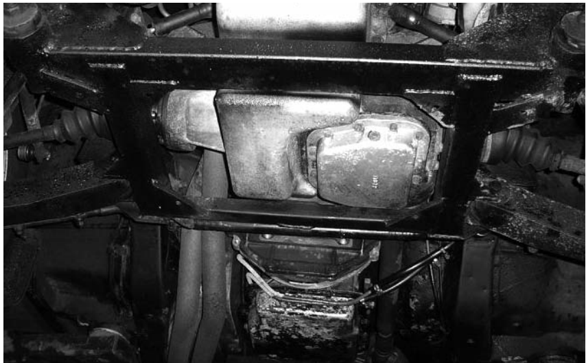
Vorderachskörper mit Differenzial und Antriebswellen vorn
