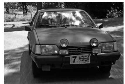
Die oben montierten Zusatzlampen konnten nachts einen Barkas-Transporter oder, einzeln geschaltet, ein Motorrad nachahmen Foto: Dave Richards
