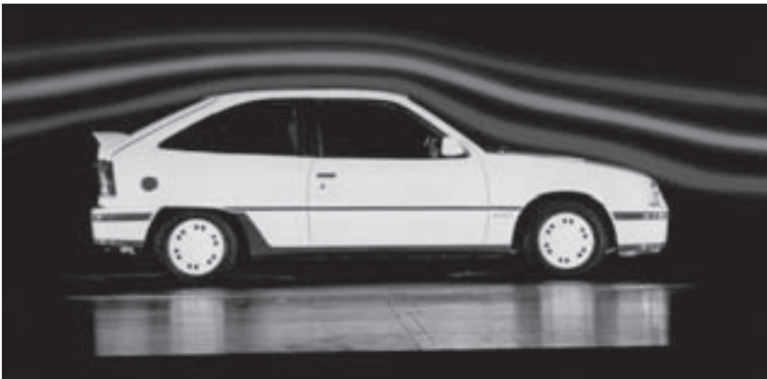
Kadett im Windtunnel – wer mit dem cw-Wert von 0,32 nichts anfangen konnte, freute sich an den hervorragenden Werten für Höchstgeschwindigkeit und Verbrauch
